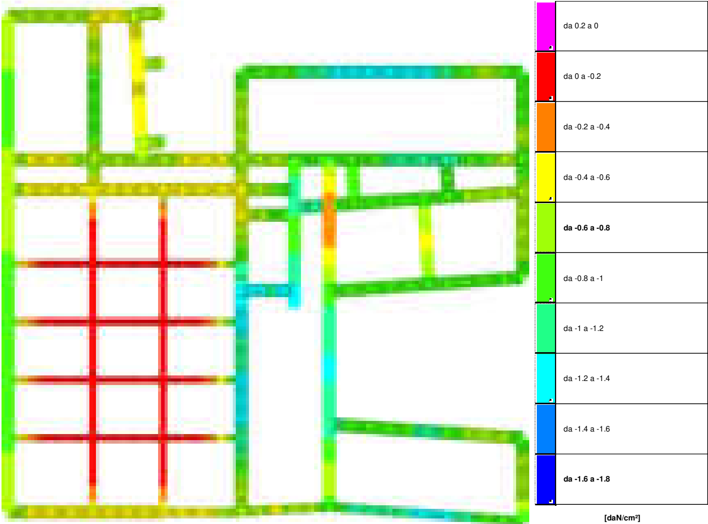
Rappresentazione in pianta delle massime compressioni sul terreno in famiglie SLE/SLD.
