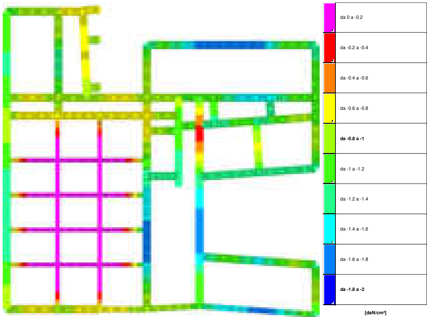
Rappresentazione in pianta delle massime compressioni sul terreno in famiglia SLU.
