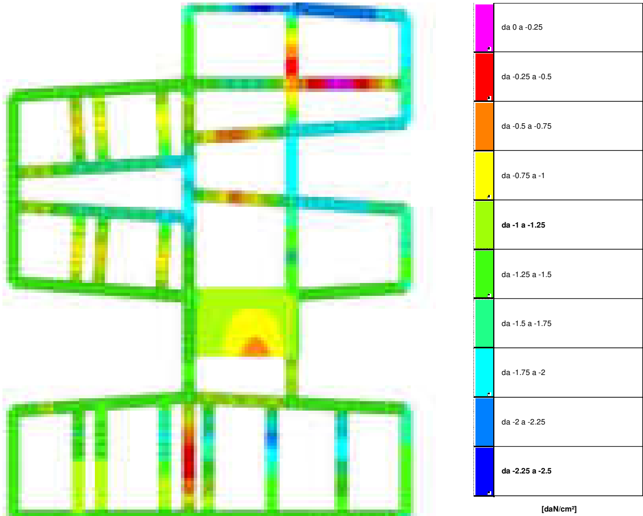
Rappresentazione in pianta delle massime compressioni sul terreno in famiglia SLU.
