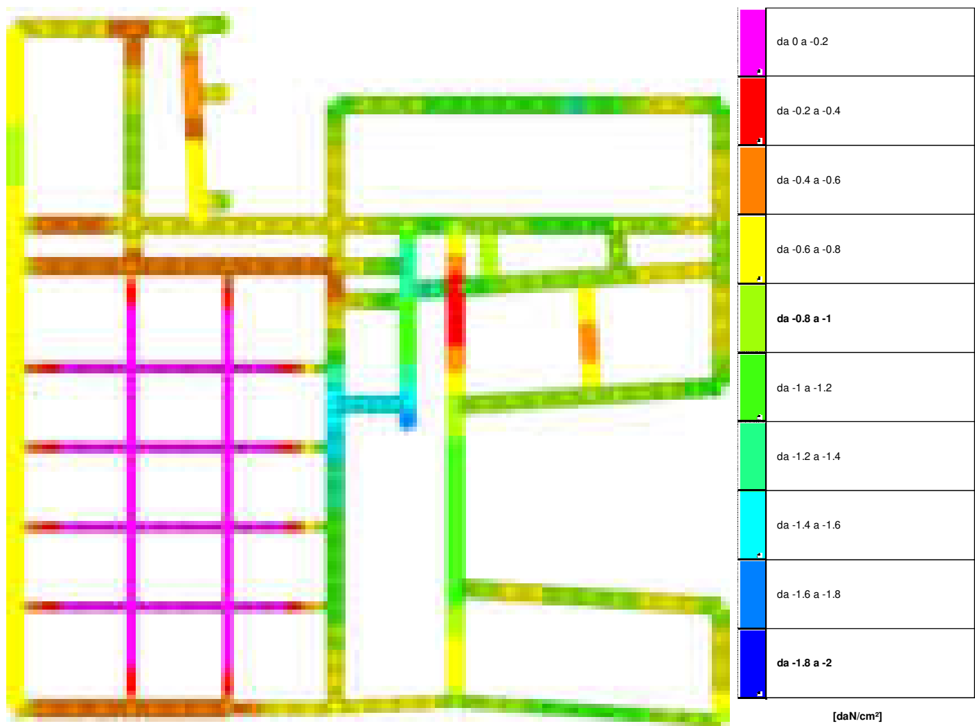
Rappresentazione in pianta delle massime compressioni sul terreno in famiglie SLV/SLVf/SLUEcc.
