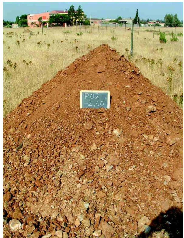
Fig. 8: Ripresa fotografica del materiale granulare estratto dal Pozzetto P1 (-2.40 m)
