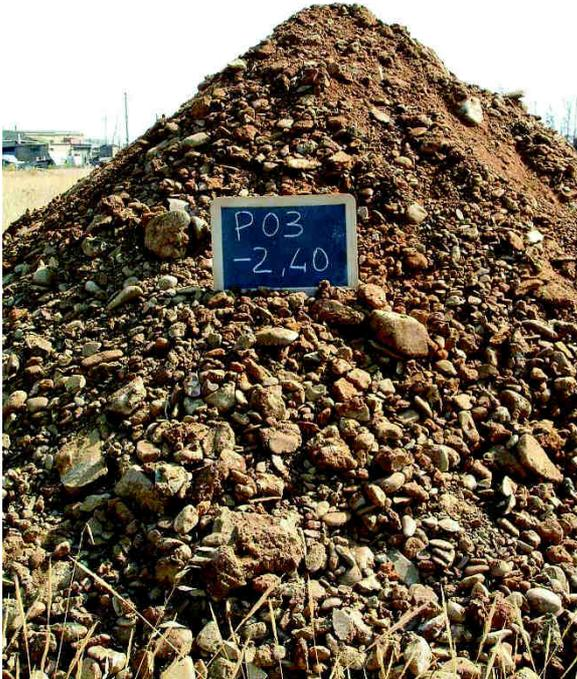
Fig. 9: Ripresa fotografica del materiale granulare estratto dal Pozzetto P3 (-2.40 m)
