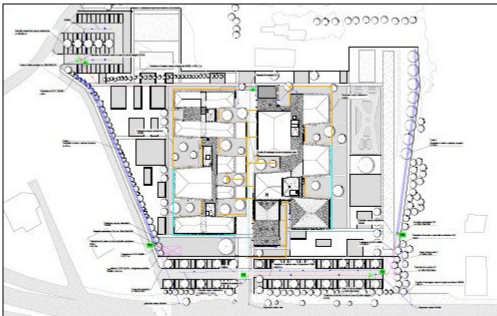
Figura 12 – Posizione delle vasche di accumulo e rete di drenaggio.
