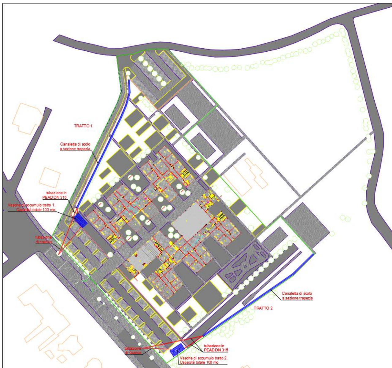
Figura 14 – Posizione delle vasche di laminazione (rettangoli blu) e rete di drenaggio.
