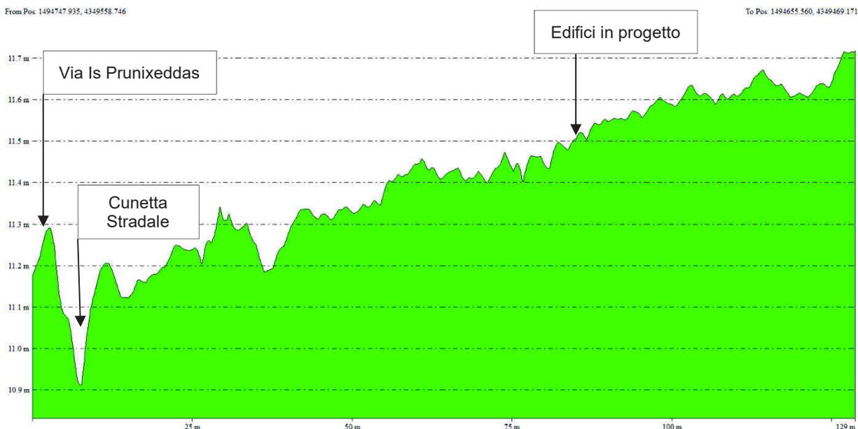
Fig. 49 –Modello altimetrico dell'area d'intervento – profilo topografico trasversale area d'intervento
