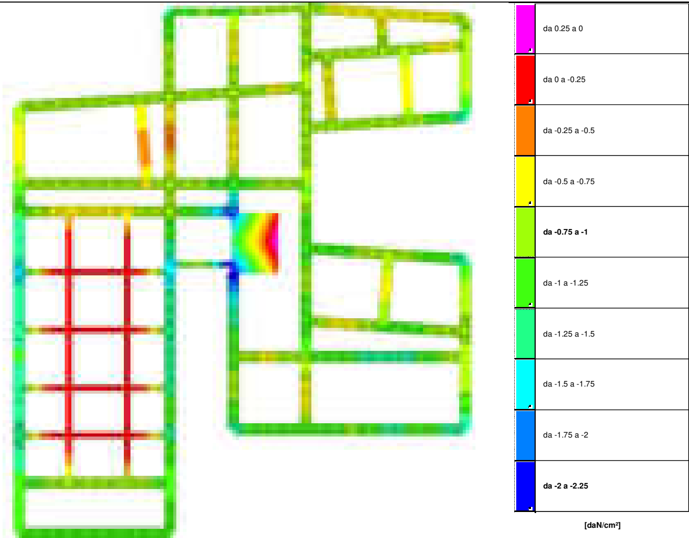
Rappresentazione in pianta delle massime compressioni sul terreno in famiglie SLV/SLVi/SLUEcc.
