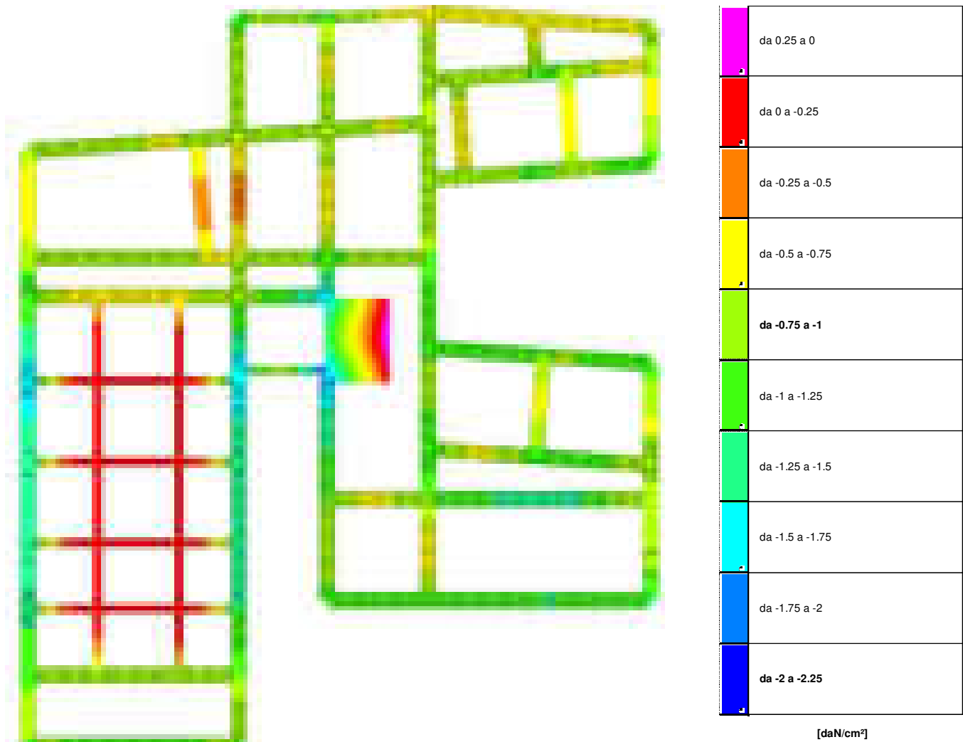
Rappresentazione in pianta delle massime compressioni sul terreno in famiglie SLE/SLD.
